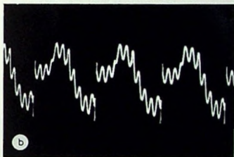
Bild 13. Oszillogramme der Ausgangsspannung der Tonabnehmer A und B bei der Abtastung des Frequenzpaares (400 + 4000) Hz von der TTR 103, Seite 2, Band 5... 8, bei verschiedenen Schnellen; a) bei 19 cm/s, b) bei 24 cm/s; (System A), c) bei 24 cm/s (System B) ▶
