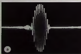
Bild 8. Abtastverzerrungen D_M in % von zwei Hi-Fi-Stereo-Tonabnehmern beim Abtasten (Kanal L) der 10,8-kHz-Tonbursts auf der Shure-Testplatte TTR 103 (Band 1...4, Seite 1, 45 U/min) in Abhängigkeit von der Schnelle: 1,5 p; Laufwerk Dual „701“
